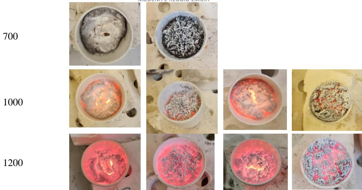
Figura 2 – Analisi visiva per i provini N.1 e N.2 ad ogni step dei trattamenti termici
